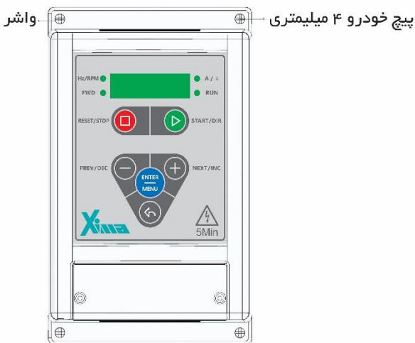
شکل ۷ - نمایش نصب دستگاه به صورت تراز با سطح افق
