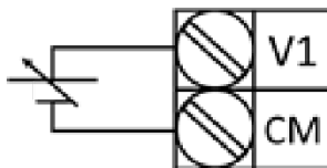
استفاده از منبع ولتاژ خارجی و متغیر
