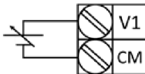
استفاده از منبع ولتاژ خارجی و متغیر
